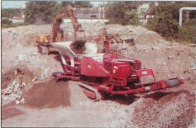
▲ Prowadzone przez „Legmet” centrum recyklingu we Wrocławiu. Gruz ze zniszczonych w czasie wojny kamienic (przykryty do tej pory warstwą ziemi) jest przetwarzany na granulaty dla budownictwa i drogownictwa. ▼
