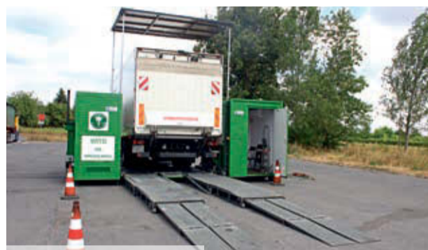
Mobilna linia kontroli pojazdów ma własne zasilanie, więc kontrola może być przeprowadzona praktycznie wszędzie
