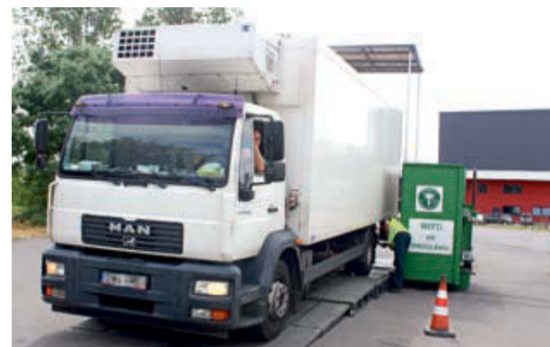
Mobilna linia kontroli pojazdów ma własne zasilanie, więc kontrola może być przeprowadzona praktycznie wszędzie
