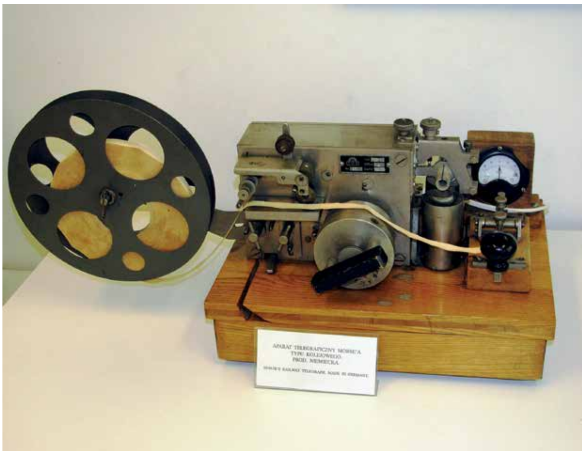
Rycina 5. Aparat Morse'a z Muzeum Poczty i Telekomunikacji we Wrocławiu. Dokładnie takie aparaty były w użyciu na nastawni dysponującej stacji Rudna Gwizdanów. Mechanizm sprężynowy widoczny w środku zdjęcia przewijał ruchem jednostajnym papierową taśmę z zasobnika ukrytego w pudle na zewnętrzną rolkę widoczną z lewej strony. Kreski i kropki były rysowane przez maczane w tuszu kółeczko dociskane do taśmy w rytm pracy klucza w stacji nadawczej. Własną korespondencję nadawało się kluczem telegraficznym widocznym z prawej strony kadru. Fot. Z. Kletowski
