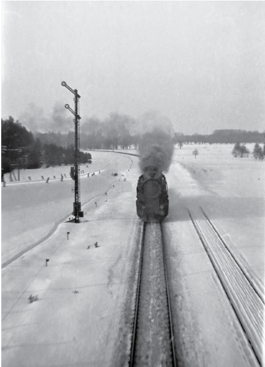
Rycina 4. Parowóz nadjeżdżający na stację od strony Głogowa. Wyraźnie widoczne jest cięgło drutowe biegnące poza semafor wjazdowy dalej do niewidocznej już tarczy. Ona jako pierwsza sygnalizowała maszyniście pociągu czy semafor jest w pozycji „stój”, czy też „wolna droga” (pierwsza połowa lat 60.). Fot. Z. Kletowski
