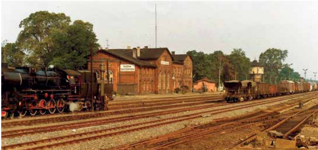
Rycina 3. Parowóz pociągu towarowego nabierający wodę z żurawia stacyjnego. W dali widać stacyjną wieżę ciśnień, a na dachu budynku wysoki maszt anteny radiotelefonu zamontowanego do szybkiego kontaktu z Lubinem i Polkowicami. Radiotelefon ten nie spełniał należycie swojej roli i został wkrótce zdemontowany. Fot. Z. Kletowski
