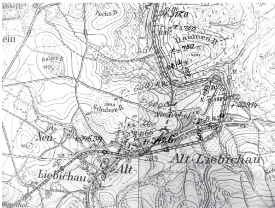
Źródło: Zbiory prywatne autora. Rycina 3. Niezrealizowany plan budowy tunelu kolejowego w okolicach Lubiechowa z 1908 r. na uruchomionym w 1853 r. krętym szlaku Świebodzice-Wałbrzych-Szczawienko
