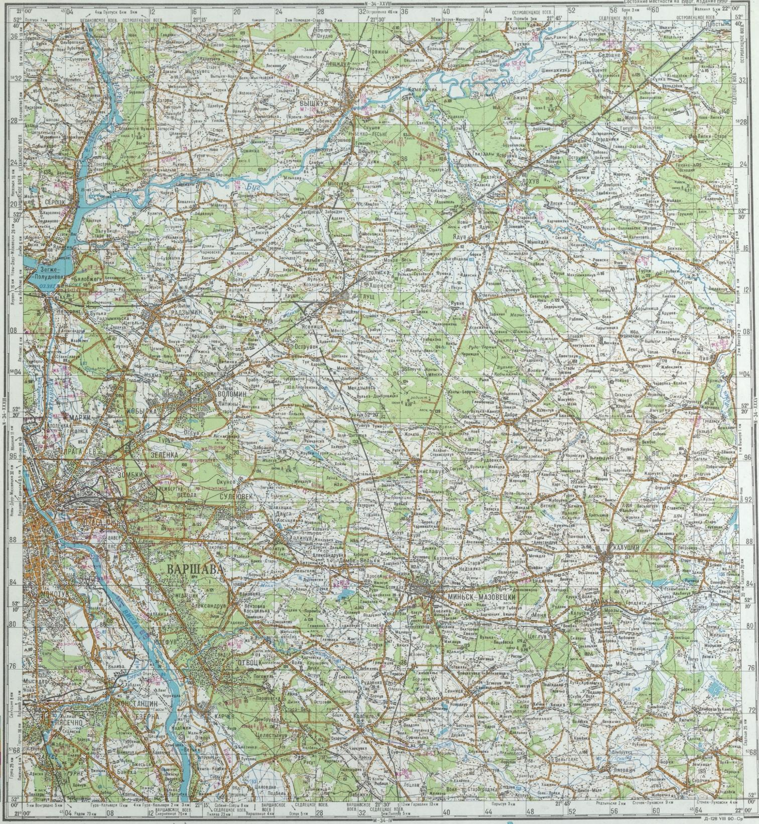
Склонение на 1990 г. восточное  $3^{\circ}13'$ . Среднее сближение меридианов восточное  $0^{\circ}24'$ . При прикладывании буссоли (компаса) к вертикальным линиям координатной сетки среднее отклонение магнитной стрелки восточное  $2^{\circ}49'$ . Годовое изменение склонения восточное  $0^{\circ}05'$ .
