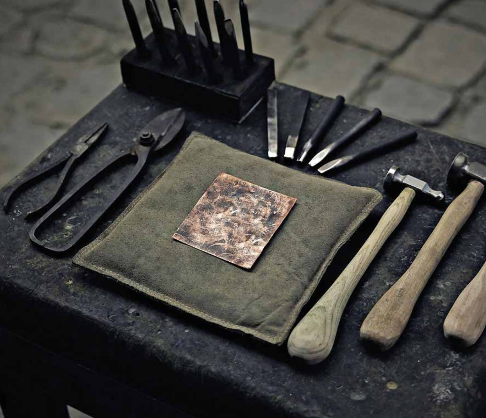
Podstawowe narzędzia repusera (zestaw puncyn, młotki cyzelerskie, poduszka z piaskiem)
