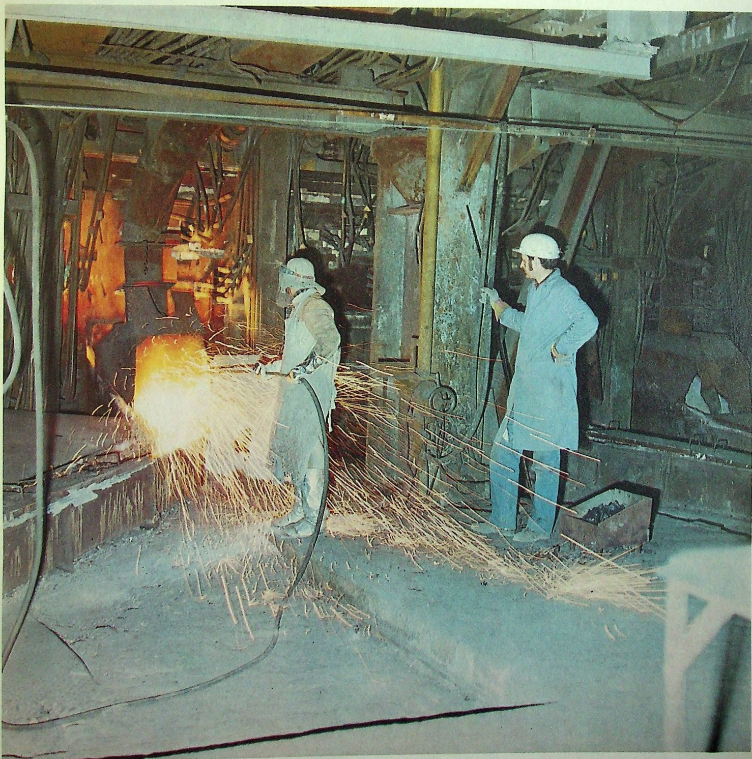
Spust miedzi blister z pieca zawieszinowego na Wydziale Metalurgicznym Huty Miedzi „Głogów” — II. Nad przebiegiem procesu czuwają: spustowy Waldemar Kostro oraz starszy mistrz Czesław Dominik.
