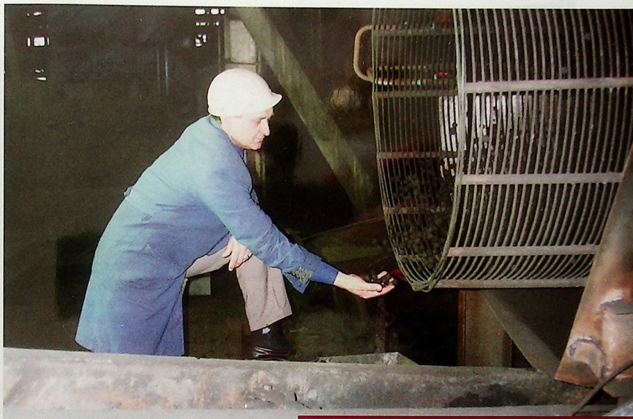
Na wydziale przygotowania wsadu przy próbach granulacji koncentratu. Lata 90.
