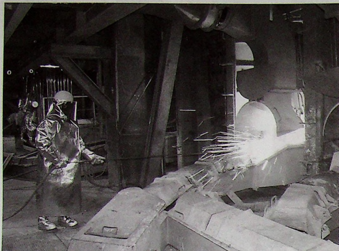
Huta Głogów II, 18 lutego, moment przepalania otworu spustowego w piecu zawieszinowym. Za chwilę popłynie trzymilionowa tona miedzi blister. Fot. Zbigniew Nowakowski
