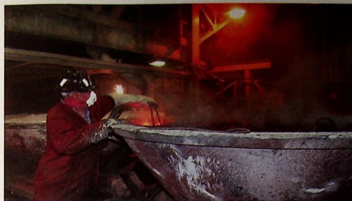
Żuźlowe babki wyciąga się z kadzi przy pomocy specjalnych uchwytych zwanych ankrami
